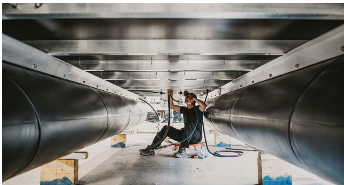
Blick unters Boot: Was hier aussieht wie Rohre sind die Schwimmkörper des Rollyboot Max.
