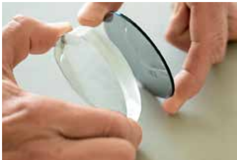
Links der Rohling, rechts das fertige Brillenglas: fast 70 Prozent der Masse fallen beim Schleifen weg.
